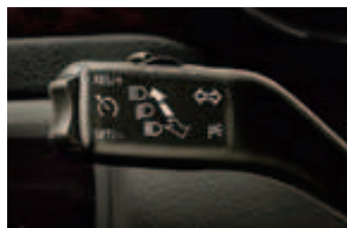
Устройство регулирования скорости (круиз-контроль) для всех версий двигателей для автомобилей с встроенным бортовым компьютером (ЗТО 054 690); для автомобилей без встроенного бортового компьютера (ЗТО 054 690А)
