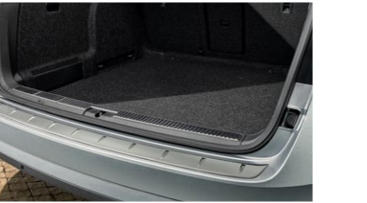
**Декоративно-защитная пластина из нержавеющей стали для заднего бампера универсала SUPERB COMBI**
